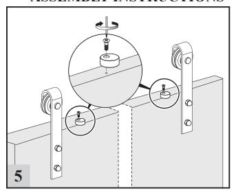
INSTALLING THE ANTI-JUMP DISCS
